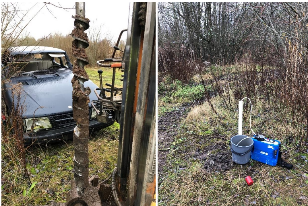
Figur 15. Till vänster: Jordprovtagning i punkt 22Ty30, 0-1 m u my. Till höger: Renspumpning av installerat grundvattenrör. 2022-11-15/16.
