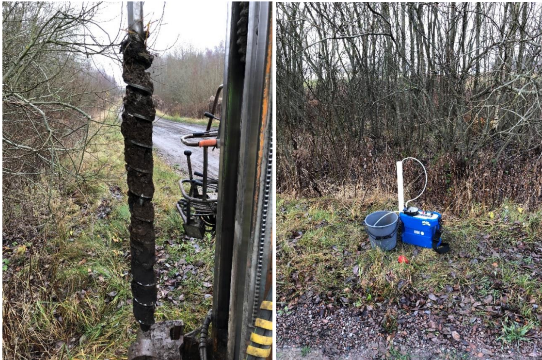
Figur 1. Till vänster: Jordprovtagning i punkt 22Ty23, 0-1 m u my. 2022-11-15. Till höger: Renspumpning av installerat grundvattenrör. 2022-11-16.
