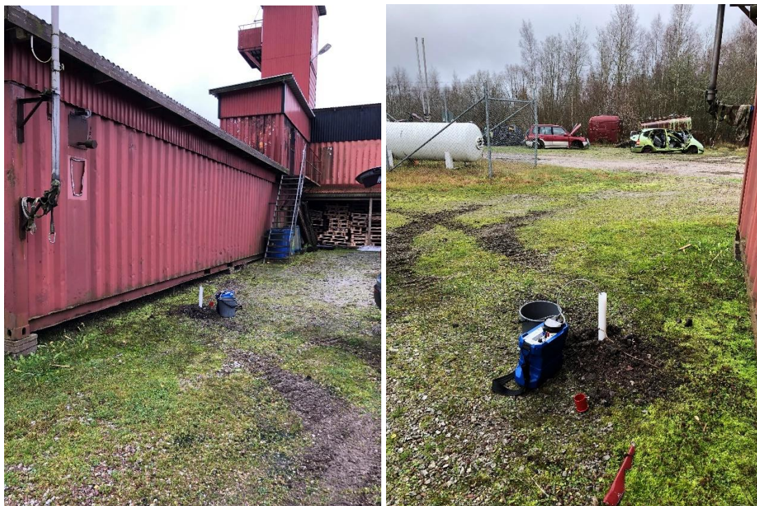
Figur 14. Renspumpning av installerat grundvattenrör i punkt 22Ty29. 2022-11-16.
