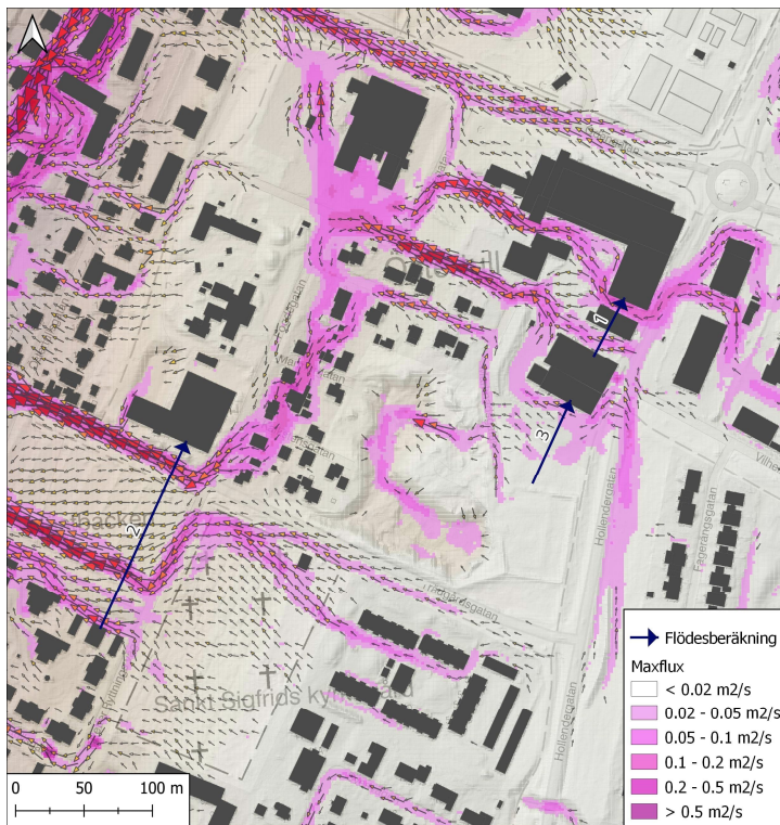
Figur 6-4 Nuvarande flödesvägar och storlek på flöden. I tre platser har flödesberäkningar utförts. För att testa om det är möjligt att minska vatten volymer inom planområdet samt minska flödet till lågpunkten/lågstråket genom villakvarteren runt Vavgatan, Marmorgatan och Kalkstensgatan har en alternativ höjdsättning på Höllendergatan samt två stråk in mot tidigare bergtäkt testats i skyfallsmodellen. Hur vatten föreslås styras ses i Figur 6-5. Utöver detta har även mindre höjdförändringar testats för Fogdegatan.
