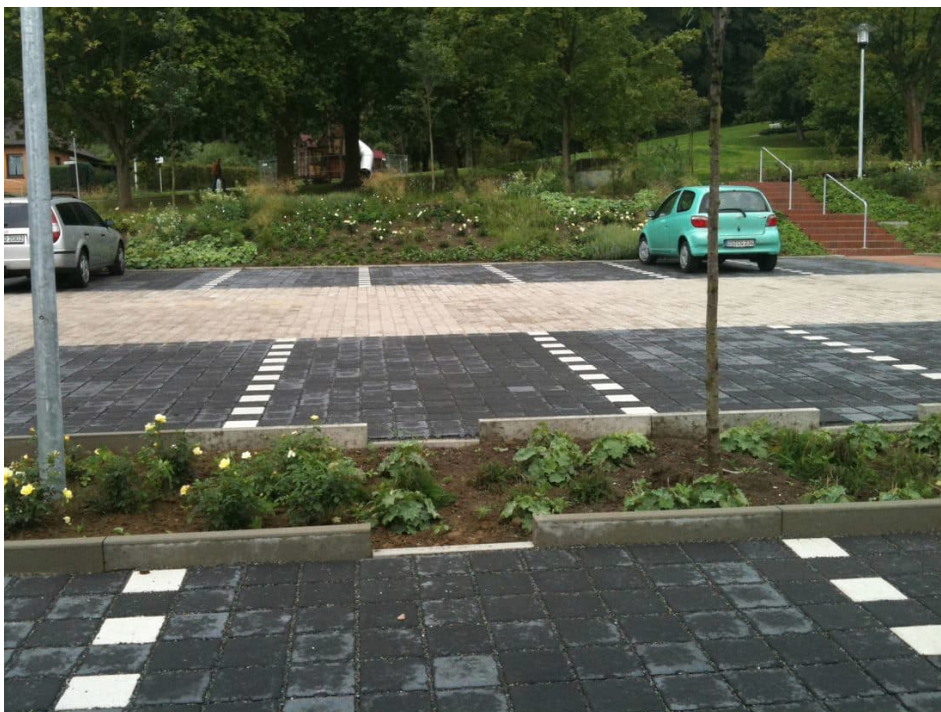
Figur 5-2 Exempel på nedsänkt växtbädd på parkering.
